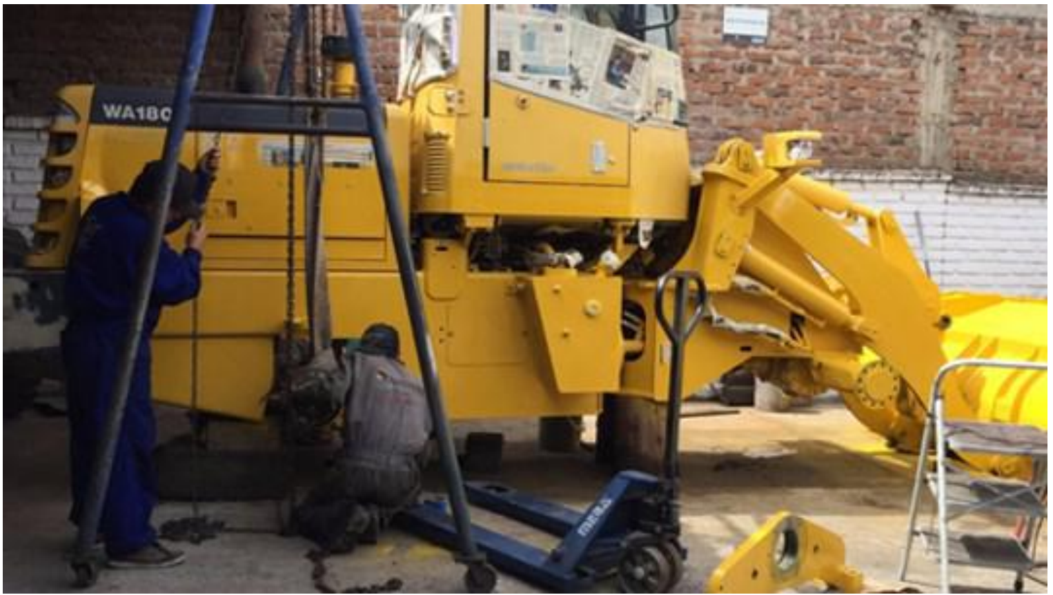
Reparacion general de cargador frontal de la municipalidad distrital de Chongos Alto Huancayo.
